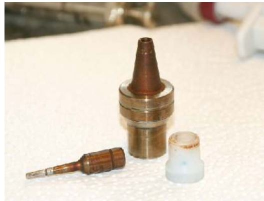
Abb.1: Ventil aus einer Hochdruckpumpe.
